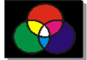
Videomonitore arbeiten beispielsweise nach diesem Prinzip. Alle darauf erkennbaren Farben bestehen in Wirklichkeit nur aus den drei additiven Grundfarben in unterschiedlichen Mischungsverhältnissen.
