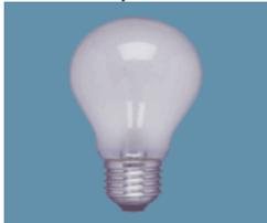
Glühlampen sind typische Temperaturstrahler, in denen ein auf ca. 2600 - 3000°K erhitzter Wolframdraht unter Vakuum oder in einer inerten Gasatmosphäre zum Glühen gebracht wird, Der Hauptanteil der abgegebenen Strahlung liegt dabei im infraroten Bereich.
